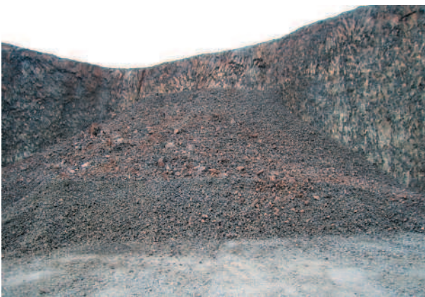
Effondrement du front de taille après un tir de mine
