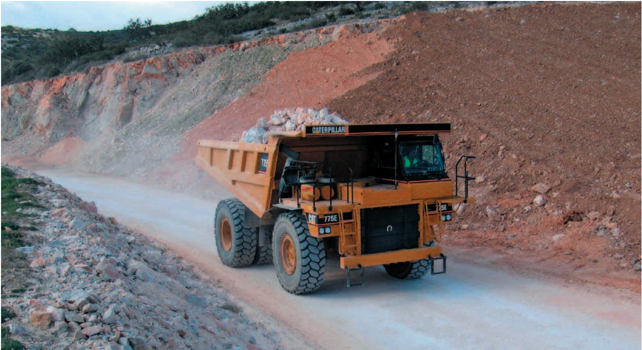
Poussière générée par un véhicule sur une piste d'exploitation
